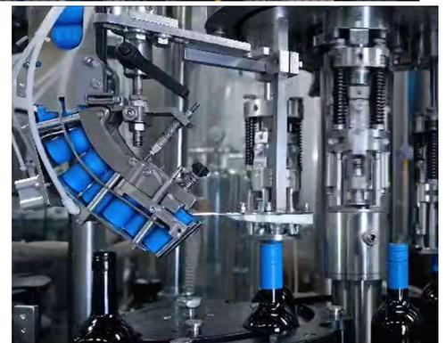
Nel 2022 è stato avviato il completamento della dell'ammodernamento della linea d'imbottigliamento inserendo capsulatrice, etichettatrice e gruppo di confezionamento fino alla preparazione del pallet che consentono all'azienda un aumento della produzione oraria. Tutti i macchinari sono stati acquistati utilizzando le risorse previste dal piano nazionale 4.0, ponendo attenzione a ottimizzare le risorse idriche e elettriche e collegando digitalmente tutta la linea d'imbottigliamento.
